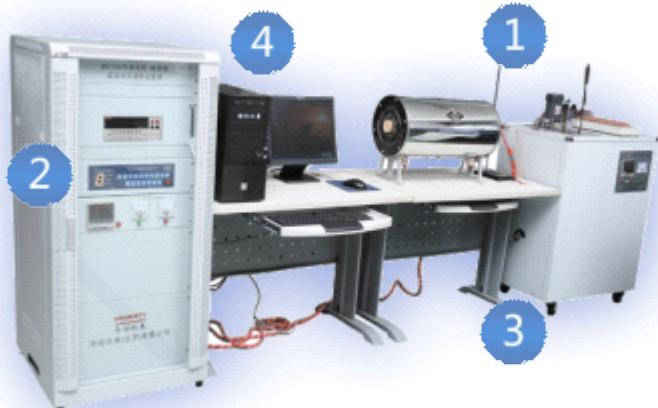
第一步：将主控系统与温场进行连接，主控系统与计算机连接
